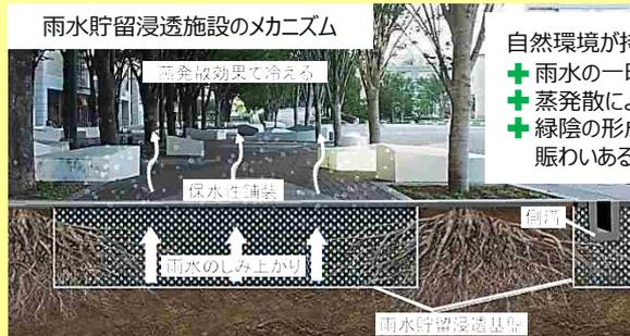
雨水を保水・浸透させると共に、植栽の成長を助け、晴天時は蒸発散効果で、ヒートアイランド対策にも寄与
