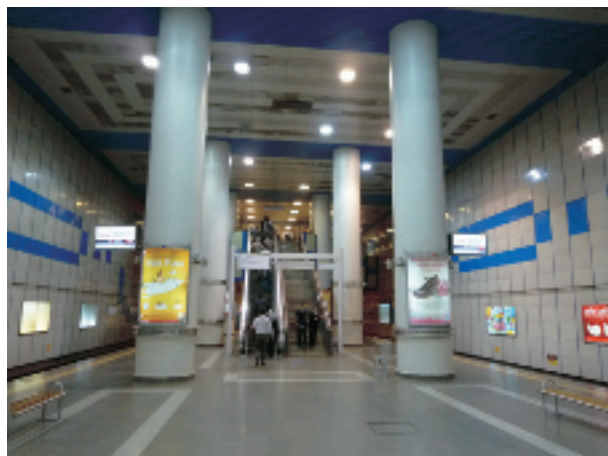
写真-19 メトロ（M2線）のレヴェント駅は開削工法で建設されたので、天井が高くて開放感がある。（北を見る。2009年11月10日）
