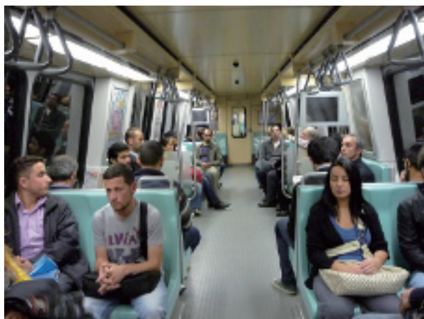
写真-18 メトロ（M2線）の車内。FRP製のボックス＝シートとロング＝シートの混在型である。（タクシム駅→4.レヴェント駅間。2009年11月10日）
