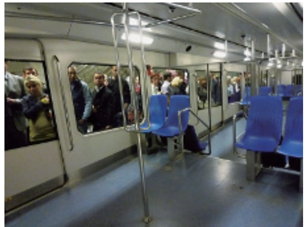
写真-23 タクシム広場とカバタシュを結ぶ地下ケーブルカー(F1線)の車内には、階段状に段差がついている。ホームの人々は、乗車を待っている。(カバタシュ駅。2009年11月10日)
