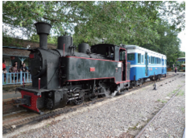
写真-18 烏樹林駅に停車中の旅客輸送用の列車。ベルギー製の蒸気機関車が日本製の木造気動車（勝利号。エンジンがついていて自走も可能）を牽引している。この日は特別に蒸気機関車と勝利号で運行していた。(2009年7月10日)
