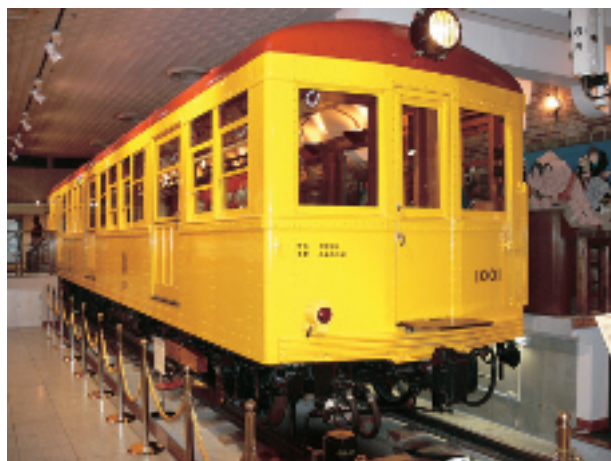
日本初の地下鉄車両 1000形（1001号車）
