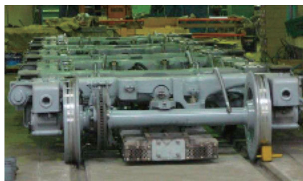
(b) 大阪市交通局鶴見車両基地でのLIMを搭載した台車
