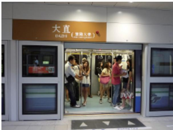
写真-19 台北MRT内湖線の大直駅(地下駅)。木柵線と内湖線では、すべての駅にホーム=ドアが設置されている。(2009年7月12日)
