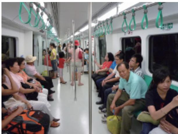
写真－8 紅線の地下区間を走る高雄MRTの車内。緑色を基調色とし、内装はすっきりとしたデザインである。FRP製のロング=シートを使用している。(進行方向を見る。2009年7月11日)
