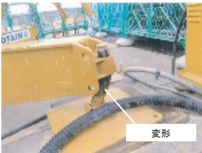
橋梁工事において据付クレーンの脚部が変形
