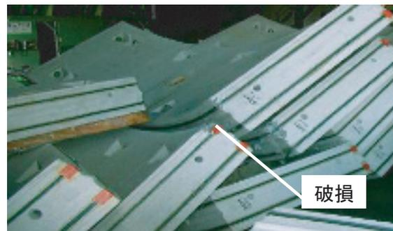
トンネルセグメントが資材ヤード内で荷崩れし破損
