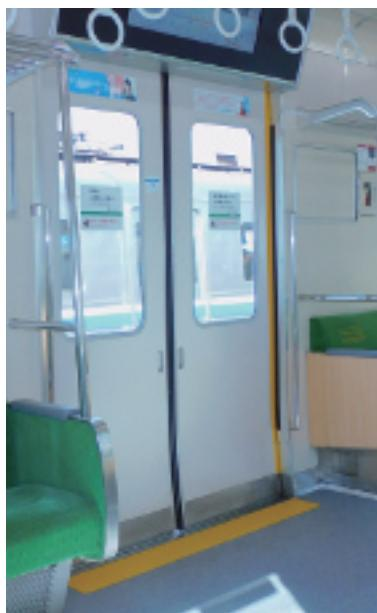
写真-8 側出入口の識別帯
