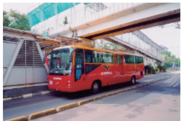
写真-15 専用レーンを走るトランスジャカルタのバス。一般道路との間には、高さが16cmのコンクリート=ブロックが設置されている。(ブロックMの1つ北にあるメスジッド=アグン (Masjid Agung = 「大きなイスラム寺院」の意) 停留所。2008年8月31日)
