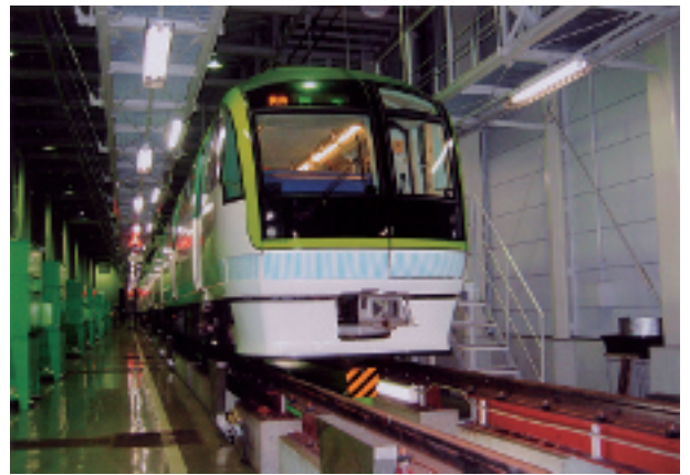
写真-5 急曲線・急勾配に適應するリニアメトロ（福岡市七隈線 橋本車両基地）
