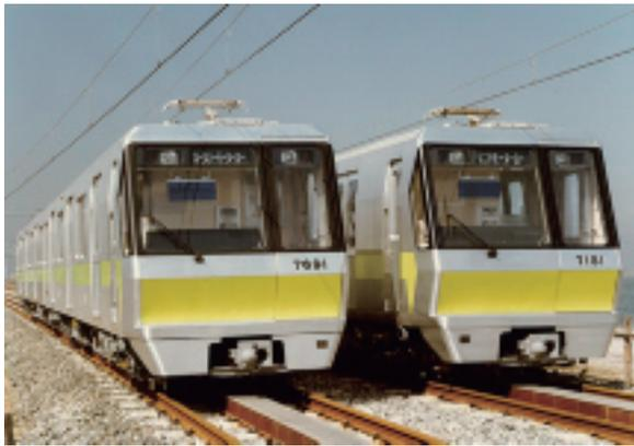
図-1 回転型モータ車とリニアモータ車
