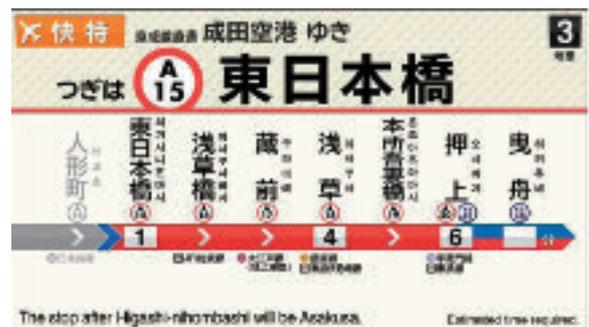
図2 車内LCD案内表示器
