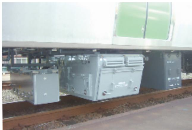
線路設備モニタリング装置
