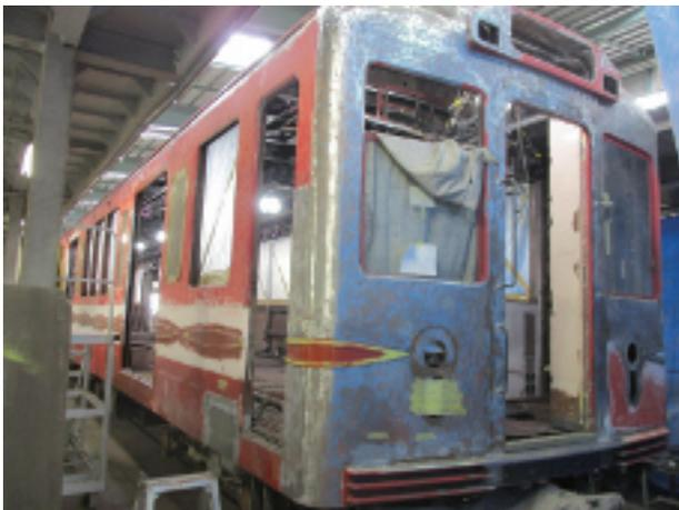
写真-5 錆落としの完了した前面
