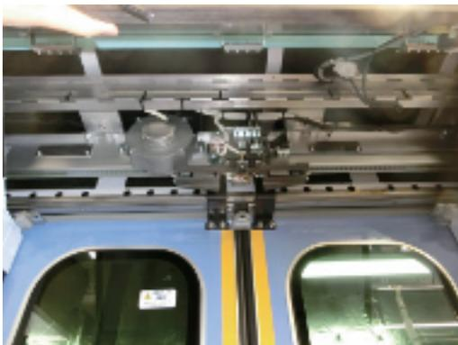
写真-10 戸閉装置 (FCPM装置)
