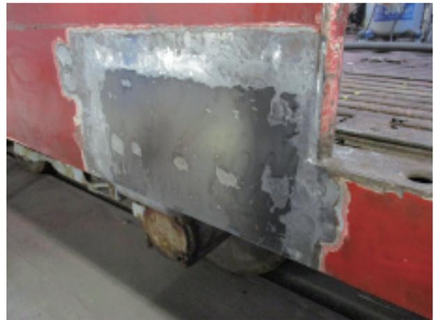
写真-6 腐食した個所を切り取り鉄板を溶接した状態
