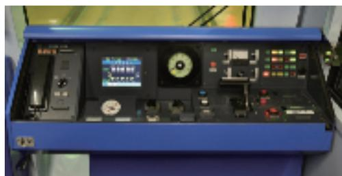
写真-4 運転台機器配置
