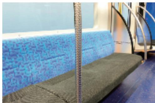
写真-5 車内縦手すり (ディンプル加工)
