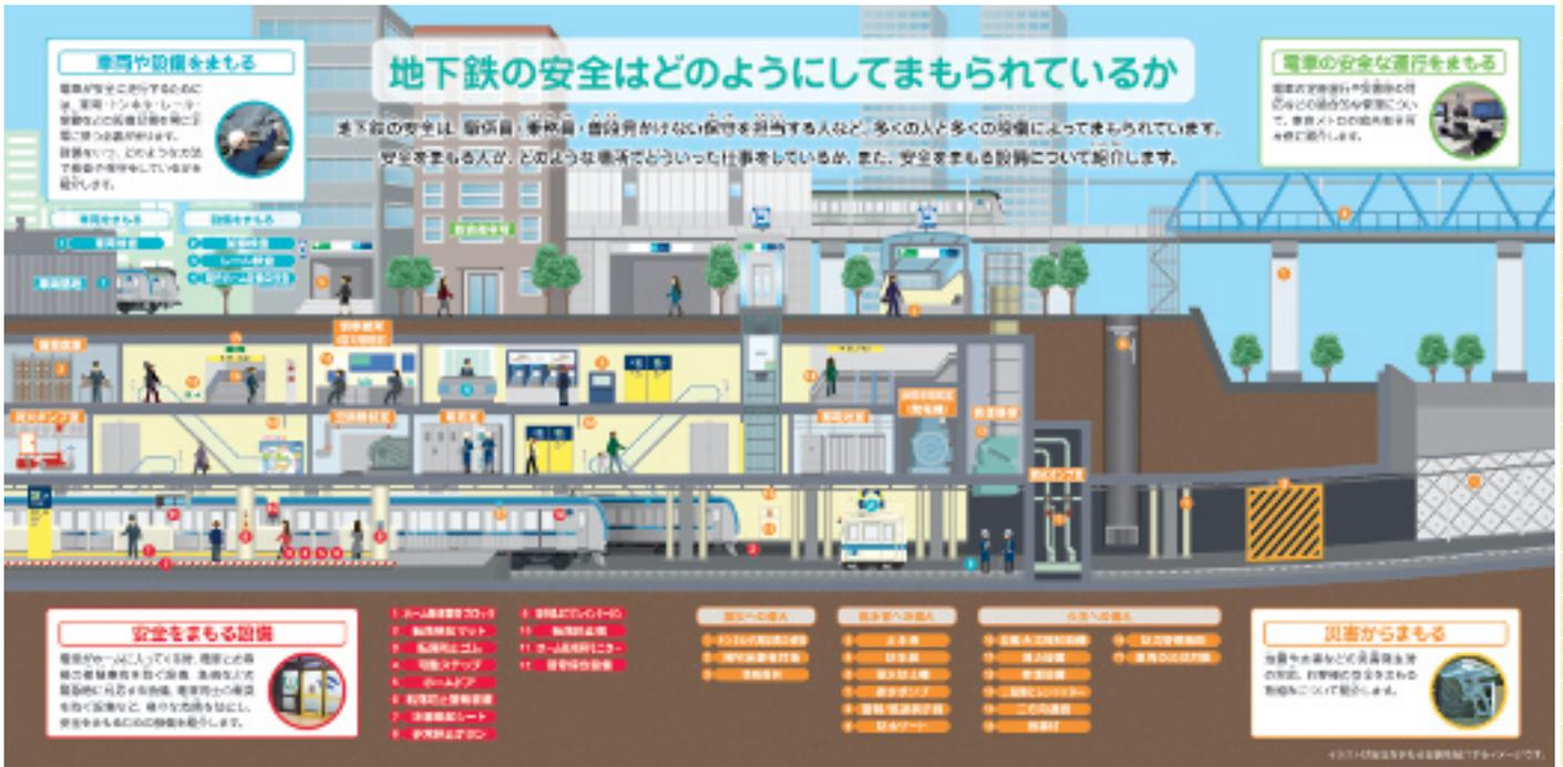
図-0 地下鉄の安全対策全体図
