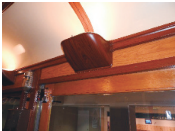
写真9：客室灯（やわらかな光の間接照明）
