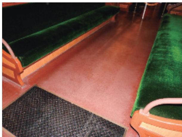
写真1：床の仕上げ材（難燃化が図られた床材）
