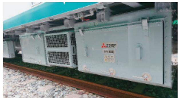
写真11 低圧電源装置
