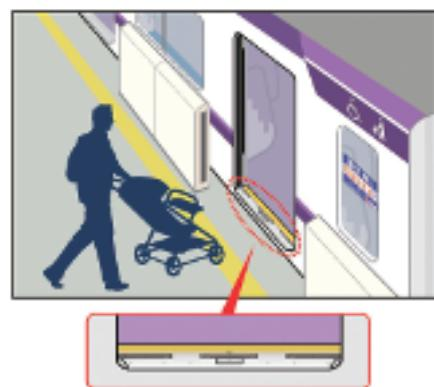
図2 ドアレールの切り欠き
