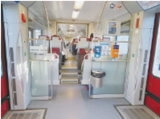
写真-92 写真-91の車内には階段があり、ドア付近にカード読み取り機、旅客情報案内機器、ゴミ箱などが設置されている。機能的で清潔感が漂う車内であるが、乗客は少ない。(2020年2月4日)
