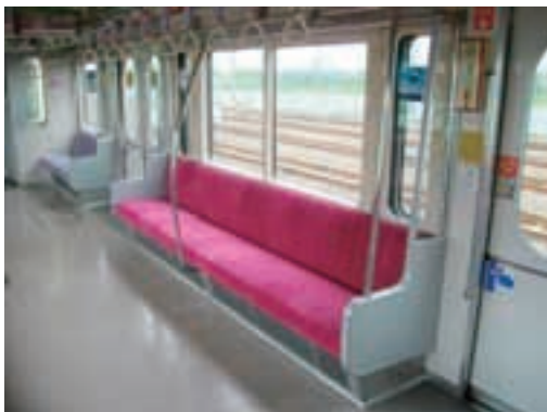
縦手すりの増設
