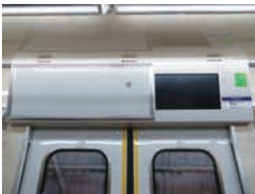
写真-4 17インチワイドLCD式車内案内情報装置
