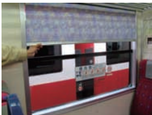
写真-3 車端寄り側窓を下降窓化
