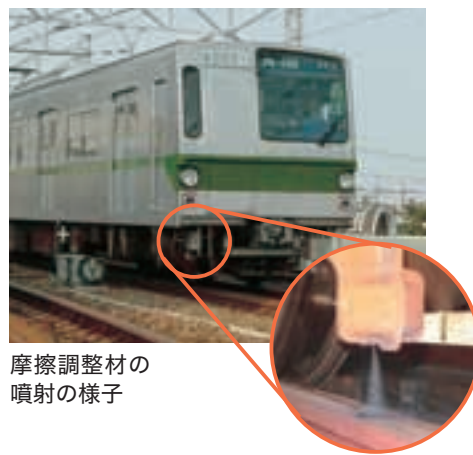
図－５ 摩擦調整材の噴射イメージ
