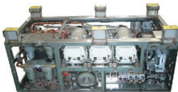
写真11 電動空気圧縮機
