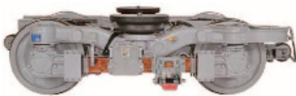
図7 台車（モーター・集電装置付）
