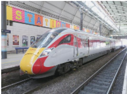
写真-5 リーズ駅に到着した「AZUMA」。イギリス鉄道規格により先頭が黄色い警戒色に塗られている。(南西を見る。2020年1月27日)
