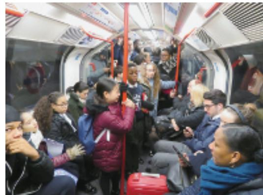
写真-10 写真-9の車内（混雑時）。深い位置に建設されたため工事費削減を目的として小断面になっている。（2020年1月28日）
