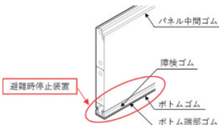
図1 ボトムパネル各部防水ゴム
