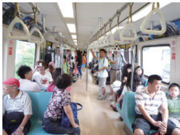
写真－4 MRT淡水線の車内。青いFRP（ガラス繊維強化プラスチック）製の座席が使われている。（電車の後方を見る。2009年7月8日）
