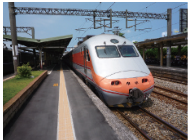
写真-11 新竹駅を出発する自強号。プッシュ=プル方式なので両端に電気機関車がついている。(後方より撮影。2009年7月9日)
