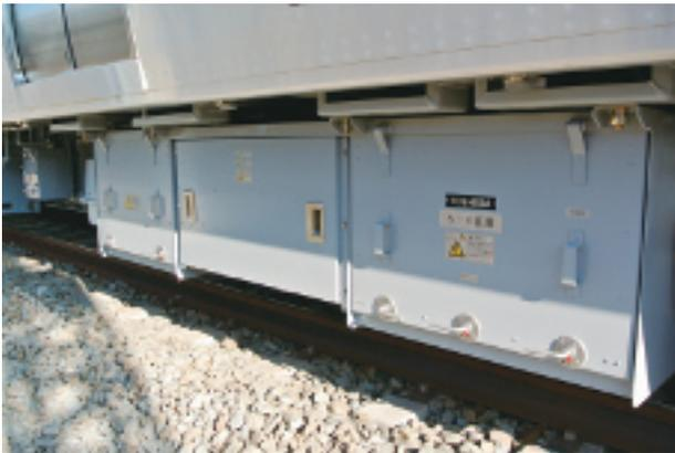
写真-6 補助電源装置
