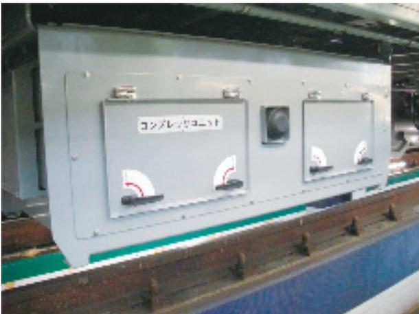
写真-7 電動空気圧縮機
