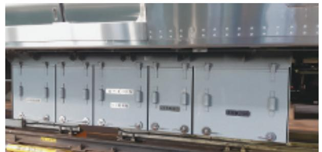
写真-8 次世代型車両情報管理装置 (N-TIOS)
