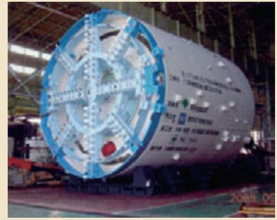
写真-2-2 雑司が谷単線シールド機仮組立の様子
