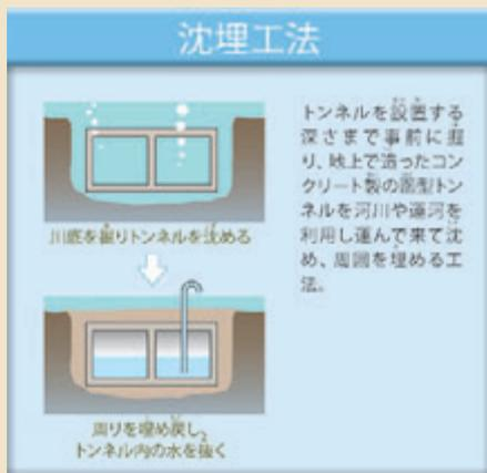
図-2-10 沈埋工法
