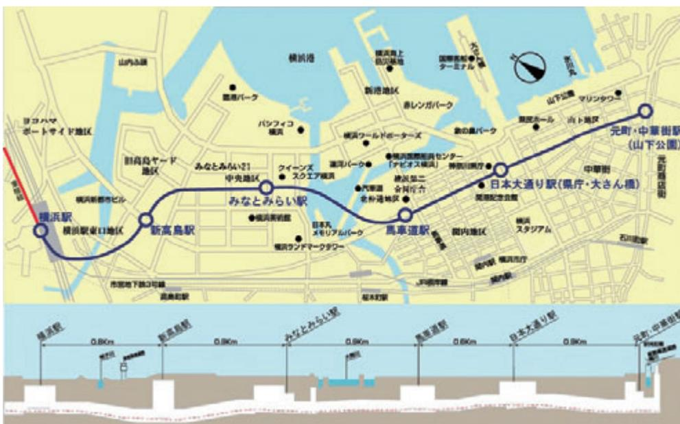
路線平面図、縦断面図
