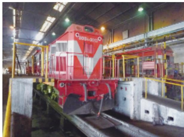
写真-19 ウィントフック=ディール車両基地内のピットで点検・修理作業中の中国製ディーゼル機関車。(2013年1月25日)
