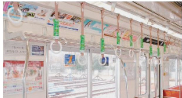
新20系車両 吊り手の高さ
