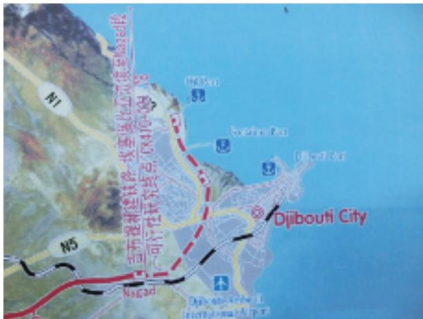
写真-23 ジブチの中心部（中央から右側）と標準軌新線のルート（赤線）。南郊のナガッドがターミナルになり、赤い破線部分が港への延伸区間である。在来のジブチ＝エチオピア鉄道は白黒の線で描かれている。右上方向が北である。（2015年4月22日）
