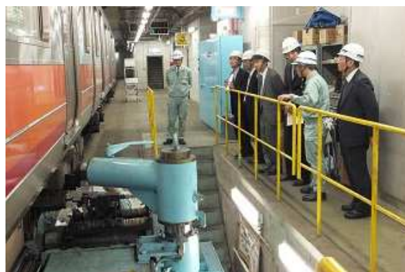
京都市交通局 醍醐車両工場 車輪削正
