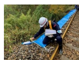
路盤の流出状況の 測定
