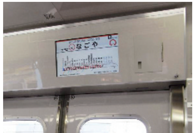
写真5 液晶式車内案内表示器 (ハッチービジョン)
