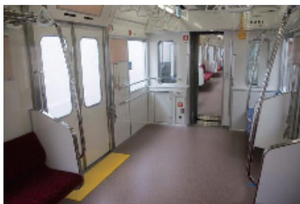
写真3 中間車両の車いすスペース
