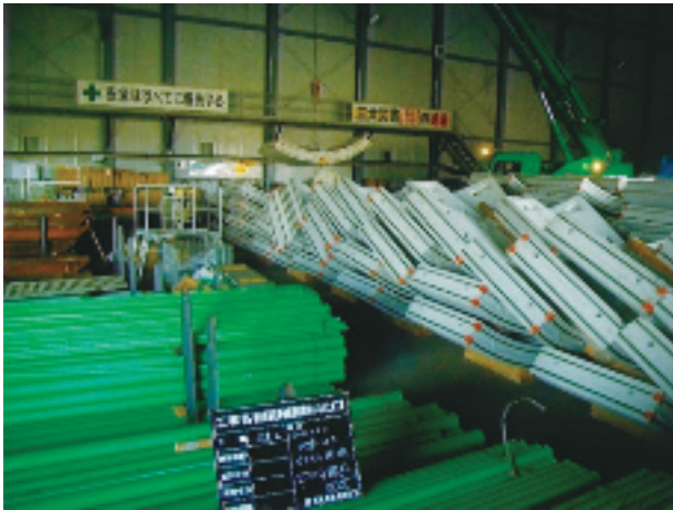
写真-6 セグメントの荷崩れ
