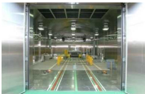
実環境試験室(試験室温度:-10~40℃)
