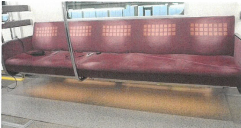
既存車を使った“足元照明”点灯試験写真
