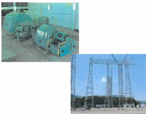
大容量短絡発電機 (2500MVA) (上) と 超高圧衝撃電圧発生装置 (12MV) (下)
