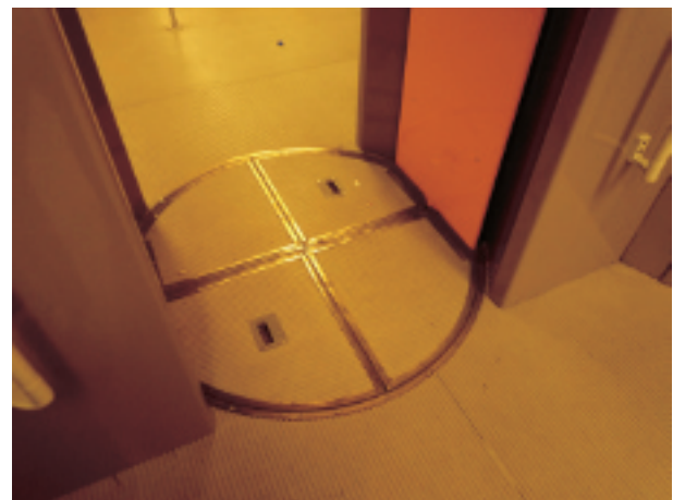
写真-3 M1線を走る電車の接続部分。(2009年11月9日)
