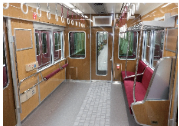
先頭車両車いすスペース
