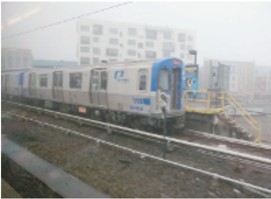
写真-1 駅に停車中の PATH (パス) 鉄道の電車とすれ違う。PATH 鉄道は第三軌条方式 (直流600V) を採用している。(2014年1月15日)
