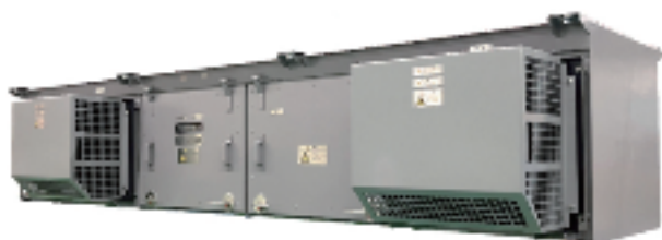
2000系VVVFインバータ制御装置
