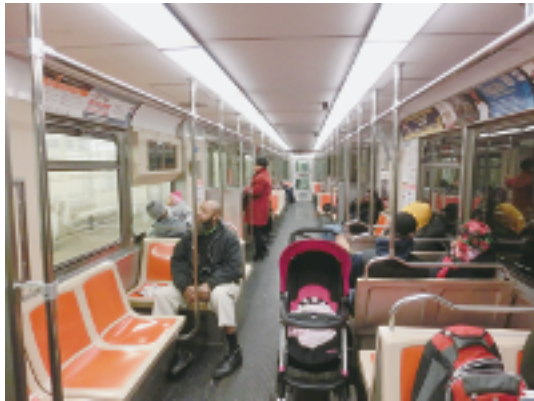
写真-9 SEPTAの南北線を走る川崎重工の電車の車内。繊維強化プラスチック (FRP) 製のセミクロスシートである。乳母車 (ベビー=カー) を携行する子供連れも乗車している。(2014年1月15日)
