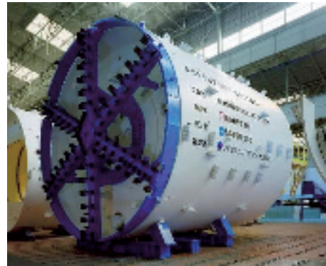
写真-6 シールド1号機
